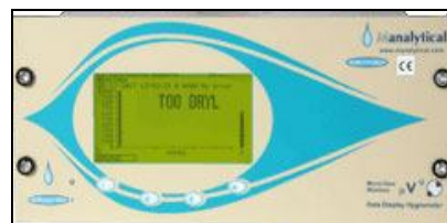
Instrument Stephens Analytical pentru măsurarea umidității în flux continuu de gaz
