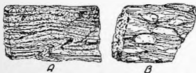
Fig. 17. — Gneiss : A-Gneiss stratificat uniform, B-Gneiss oclar de Cozia cu cristale mari de feldspat
