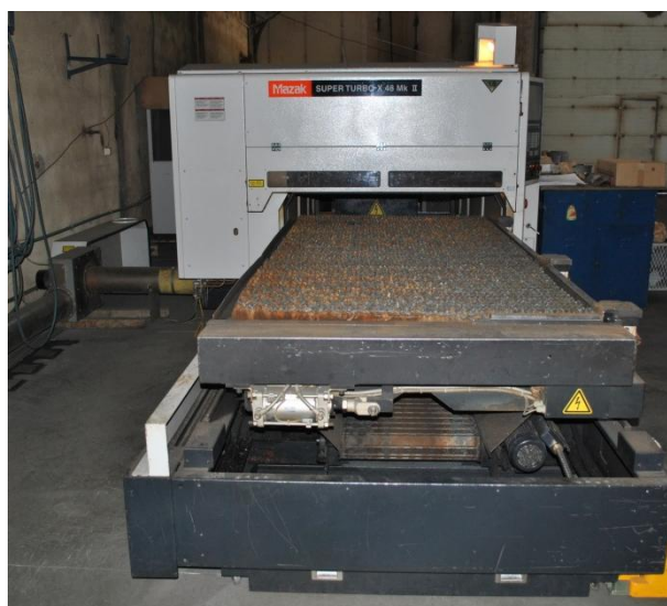
Fig. 5.1: Mașina de debitat cu laser cu comandă numerică MAZAK ST-X48 Mk II
