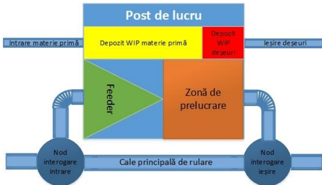
Figura 4.7 - Post de lucru generalizat într-un sistem cu feedere
