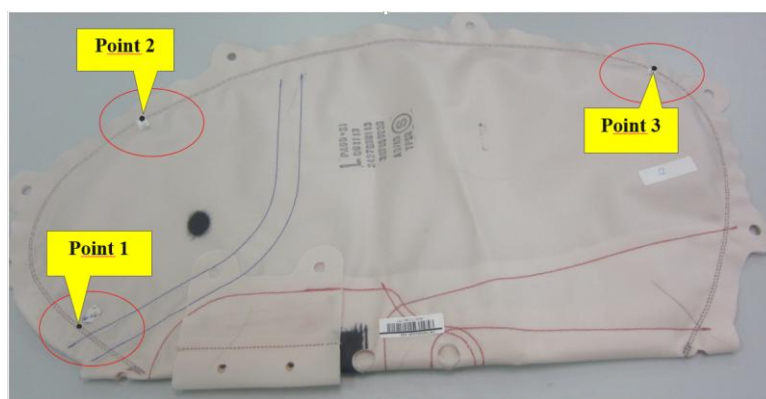
Figura 3: Selectarea punctelor critice ale probelor pentru colectarea datelor
