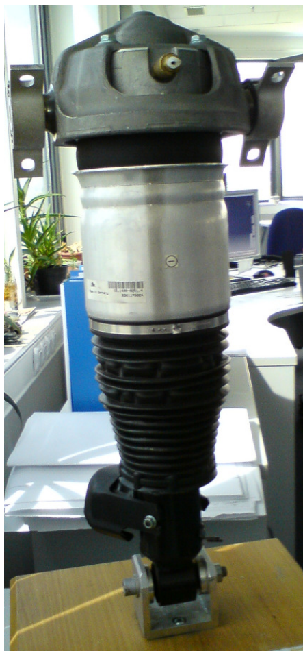
Figura 2.3.1. Suspensie pneumatică dezvoltată de Continental AG (VW Touareg / Porsche Cayenne)
