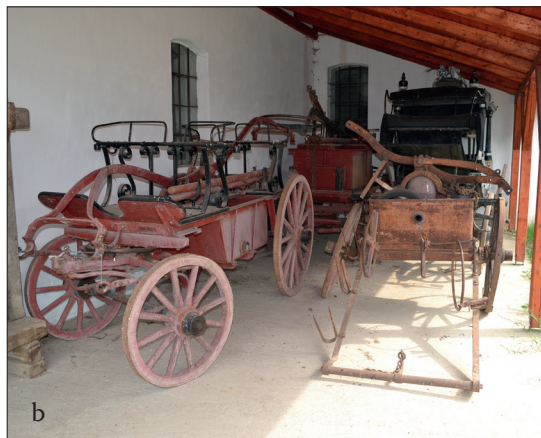
Fig. 502 b – c. Foieni (jud. Satu Mare). Atelaje de pompieri în colecția „Muzeului Morii”, b) Pompă manuală fabricată de fosta firmă „Walser” din Budapesta (model 1898); c) Pompă manuală pe căruță cu două roți tip „Köhler” (Foto: 2013)
