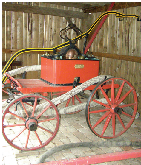
Fig. 507. Remiza de pompieri din Colun. Pompa manuală tip „Hunia” (model 1895) din dotarea Asociației Pompierilor Voluntari (Foto: Adrian Alexe, 2014)
