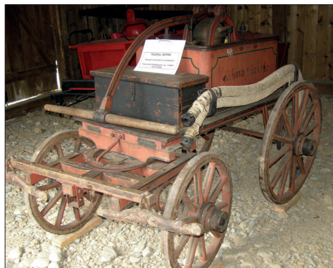
Fig. 508. Remiza de pompieri din Cacova-Fântânele. Pompa manuală fabricată la fosta firmă „Walser” din Budapesta (model 1899); pe planul al doilea se vede pompa tip „Întreprinderea Metalurgică Aiud”
