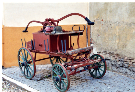
Fig. 519. Șeica Mică (jud. Sibiu). Pompă manuală montată pe trăsură hipo, tip „Seltenhofer“ (Sopron), furnizată probabil de o sucursală din Budapesta (Foto: 2013)
