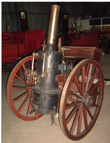
Fig. 424. București. Muzeul Național al Pompierilor: pompa cu aburi tip Merryweather, model 1895 (Foto: Vasile A. Bălan, 2014)
