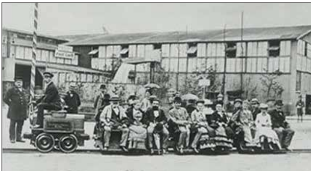
Foto 13. Primul tren electric a fost construit de firma Siemens & Halske și a circulat la Expoziția Industrială din Berlin (1879)
