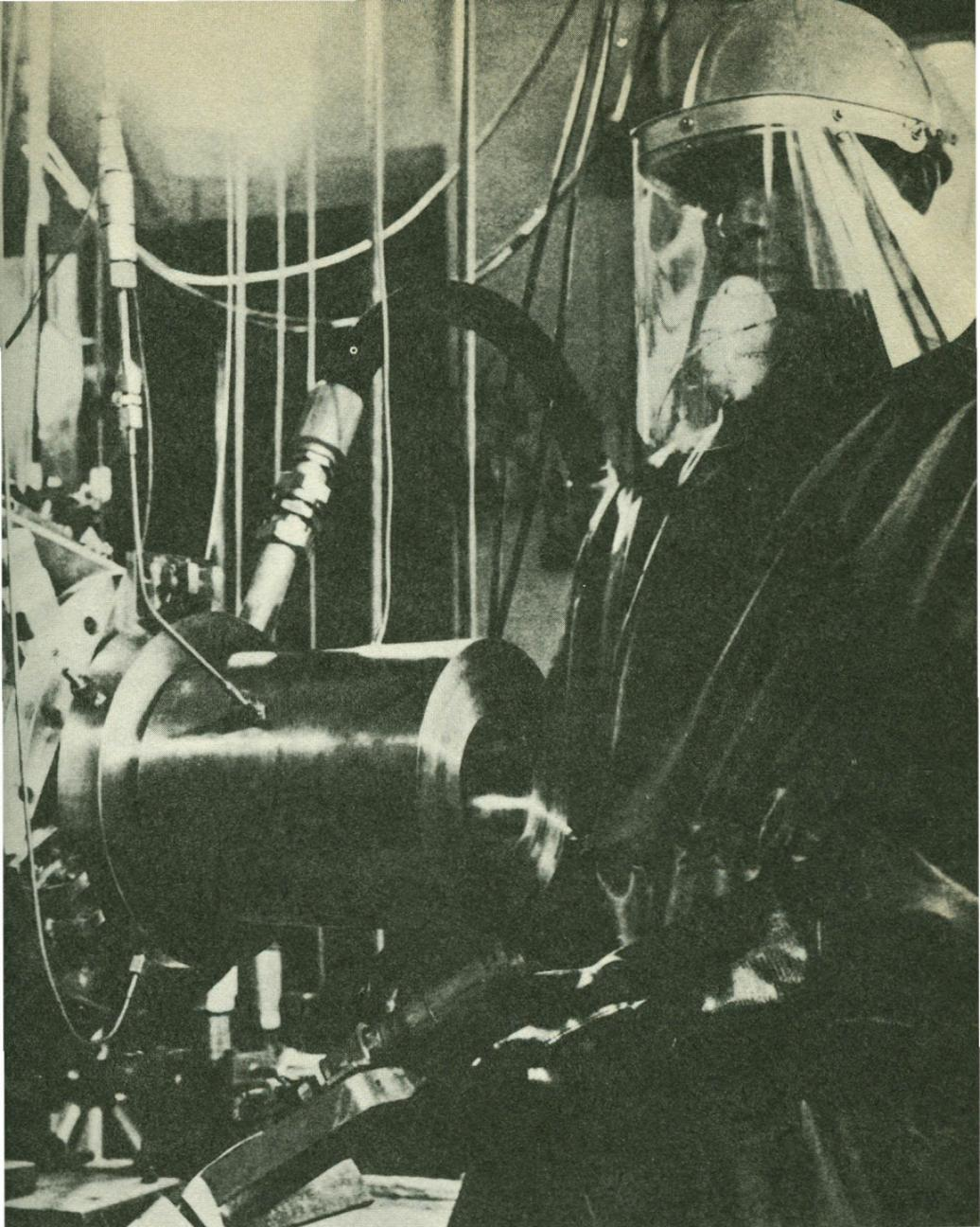
Die Raumfahrt erzwingt eine Technologie der Höchstleistungen. Hier ist es die Beständigkeit des Materials bei extrem hohen Temperaturen, die bei einem Fluor-Wasserstoff-Triebwerk von Messerschmitt-Bölkow erprobt wird.
