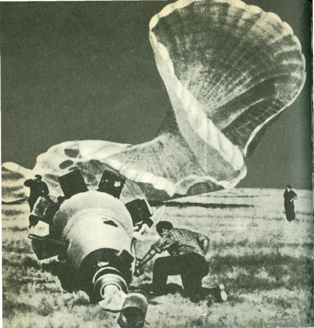
In Rußland werden zunächst ebenfalls Nachbauten der A-4-Rakete, später Eigenentwicklungen zur Höhenforschung verwendet. Das Bild oben zeigt die Fallschirmlandung einer abgesprengten Spitze, die Tiere heil zur Erde zurückbringt. — Im dicht besiedelten Deutschland soll mit gezielt zurückgeführten Flügelraketen Höhen- und Wetterforschung betrieben werden. Rechts oben die Dornier-Paragleiter-Höhenrakete in Fluglage, unten bei der Startüberprüfung.
