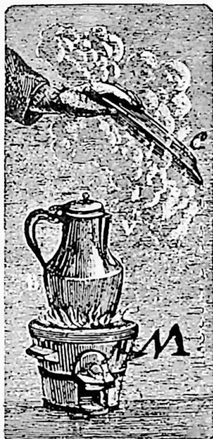
Fig. 10. Ferberea și condensarea vaporilor formați.
