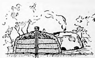
Fig. 55. Arderea necompletă a lemnelor.
