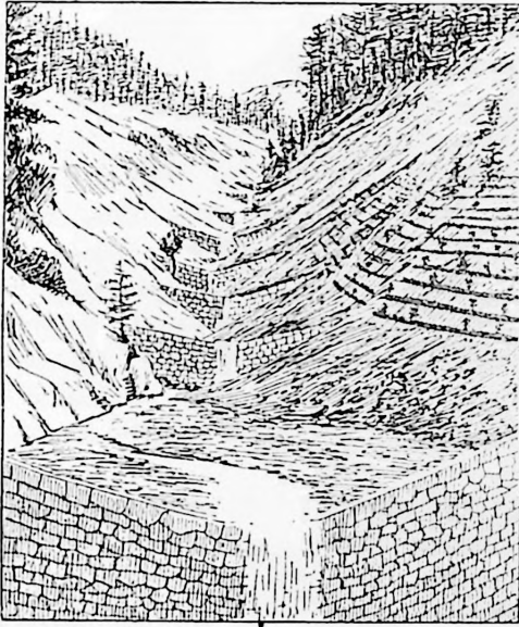
Fig. 76. Un torent corectat, a cărui apă se scurge cu încetul, iar malurile sunt împădurite.
