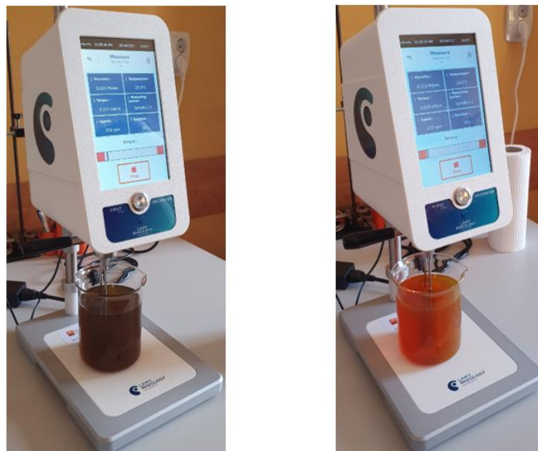
Figura 45: Măsurarea vâscozității fluidelor supuse analizei folosind tehnica DLS. În stânga lichidul de frână (vâscozitate măsurată 0,0202 daP) și în dreapta lichidul de răcire (vâscozitate măsurată 0,0102 daP).
