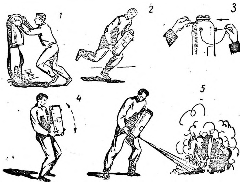
Fig. 146. — Punerea în funcție a stingătorului cu spumă chimică.
