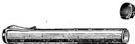
Fig. 40. — Camera de ionizare individuală (aspect exterior).
