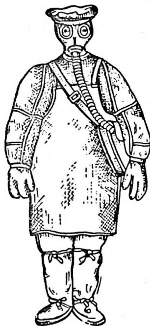
Fig. 101. — Completul de protecție nr. 2, îmbrăcat pe purtător.
