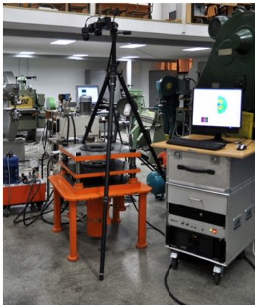
Fig. 17 Standul experimental cu sistemul optic de măsurare Aramis utilizat la încercările de întindere echibiaxială
