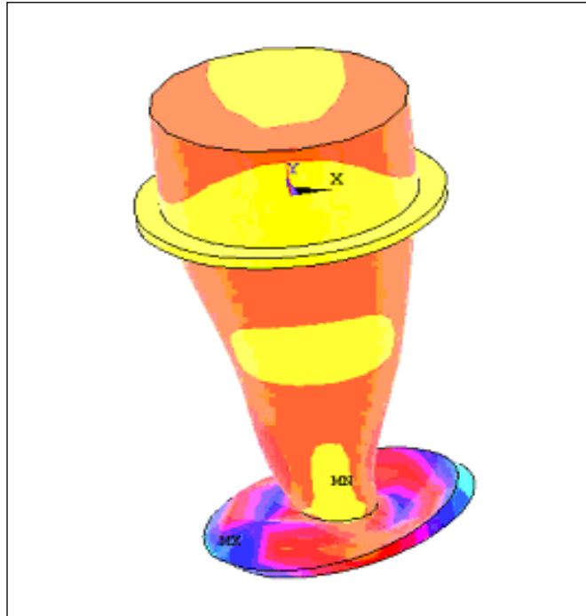
Fig. 3.17. Modul de vibrație al sistemului la frecvența f = 18700 Hz.
