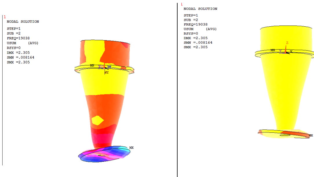
Fig. 3.18. Modul de vibrație la frecvența f_2 = 19038 Hz
