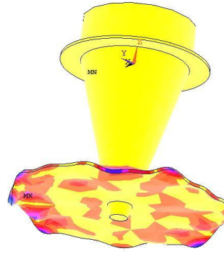
Fig. 3.26. Oscilațiile sistemului la frecvența f_3 = 18396 Hz
