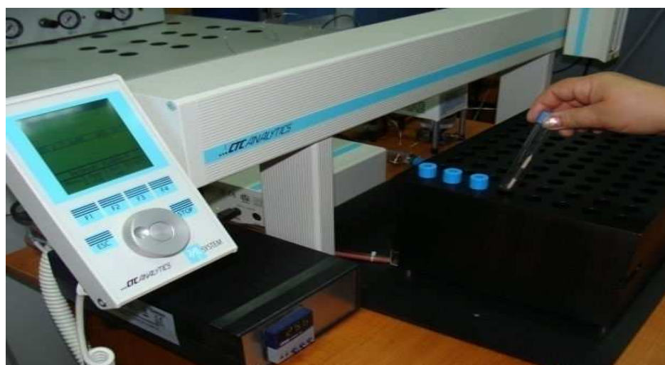
Figura 5.5.6: Introducerea fiolelor cu probe în sistemul de echilibrare GasBench II (LAFMCA ICSI Rm Vâlcea)
