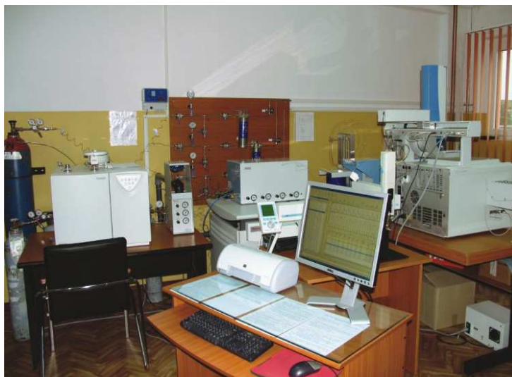
Figura 5.5.1.: Spectrometru de masă cu flux continuu pentru determinarea rapoartelor izotopilor stabili CF-IRMS DELTA V Plus (LAFMCA- ICSI Rm Vâlcea)
