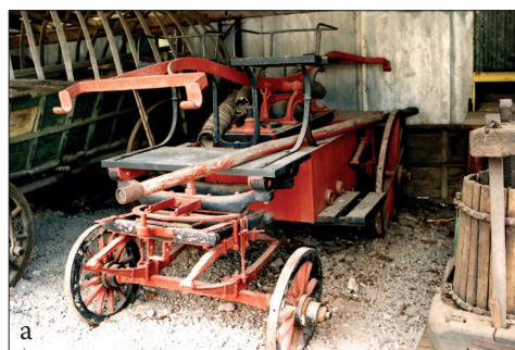
Fig. 459 a - b. Chișcău (jud. Bihor). Atelaje de pompieri în Muzeul etnografic particular „Lucreția și Aurel Flutur”; a) Pompă manuală tip „Knaust” pe trăsură hipo; b) Pompă manuală fabricată la „Întreprinderea Metalurgică Aiud”
