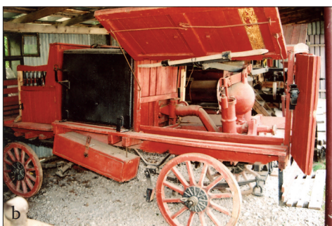
Fig. 459 a - b. Chișcău (jud. Bihor). Atelaje de pompieri în Muzeul etnografic particular „Lucreția și Aurel Flutur”; a) Pompă manuală tip „Knaust” pe trăsură hipo; b) Pompă manuală fabricată la „Întreprinderea Metalurgică Aiud”
