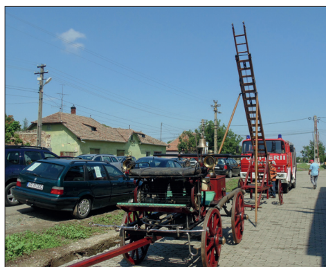
Fig 455. Vinga (jud. Arad). Pompă manuală tip „Knaust” și scară culisabilă din lemn pe atelaj tras de cai (Foto: Horia Truță, 2014)
