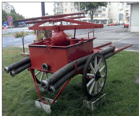
Fig. 458. Ștei (jud. Bihor). Pompă manuală montată pe cărucior cu două roți, tip „Întreprinderea Metalurgică Aiud”, model 1956 în fața cazarmii de pompieri (Foto: 2013)
