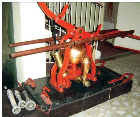
Fig. 421. București. Muzeul Național al Pompierilor: pompa manuală tip „Knaust”, model 1882 (Foto: Vasile A. Bălan, 2014)
