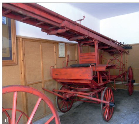
Fig. 537 a - e. Jimbolia (jud. Timiș). Pompe de stins incendii și alte atelaje de pompieri din Muzeul „Florian” : a – c) Cele două modele de pompe manuale tip „Knaust” ; d) Scară culisabilă din lemn pe atelaj tras de cai ; e) Vitrina cu diferite tipuri de căști și cupe dobândite de formațiunea de pompieri (Foto: 2012)
