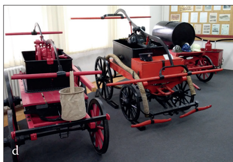
Fig. 493 a – e. Cluj-Napoca (jud. Cluj). a) Noua clădire a Inspectoratului pentru Situații de Urgență în fața căruia este expusă o pompă manuală tip „Tarnóczy“ b) Starea de conservare a pompei c) Placheta indicatoare a locului gurii de refulare și de absorție: Tömövel (= furtun); Medencé Böl (= rezervor) e) Pompa manuală montată pe trăsură hipo aflată în curtea ISU Cluj (Foto: Dan Uza, 2014)
