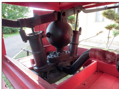
Fig. 494 a - d. Cluj-Napoca (jud. Cluj). Muzeul Apei din Florești. Pompa manuală montată pe trasură hipo, cu bazin pentru 500 l, care a funcționat la Cojocna până în anul 1980, a) Pompa acoperită în incinta Muzeului Apei; b - c) Detaliu cu pistoanele acționate de balansier și recipientul de presiune; d) Capacul rezervorului de apă (Foto: Dan Uza, 2014)
