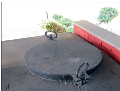
Fig. 494 a - d. Cluj-Napoca (jud. Cluj). Muzeul Apei din Florești. Pompa manuală montată pe trasură hipo, cu bazin pentru 500 l, care a funcționat la Cojocna până în anul 1980, a) Pompa acoperită în incinta Muzeului Apei; b - c) Detaliu cu pistoanele acționate de balansier și recipientul de presiune; d) Capacul rezervorului de apă (Foto: Dan Uza, 2014)
